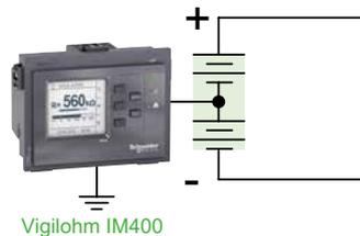
Esempio di installazione con iniezione IM400 connessa nel punto centrale della batteria.
