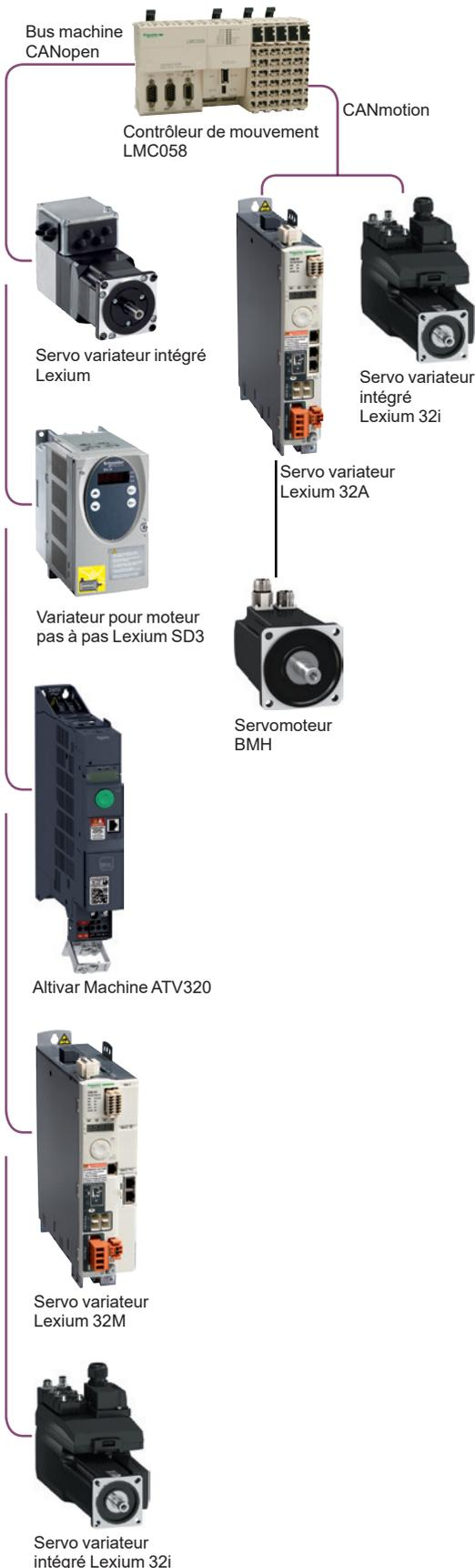
Exemple d'architecture d'automatisme avec bus machine CANopen et CANmotion
