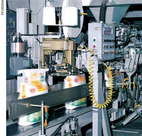
Servo variateur intégré Lexium 32i pilotant une machine d'emballage
