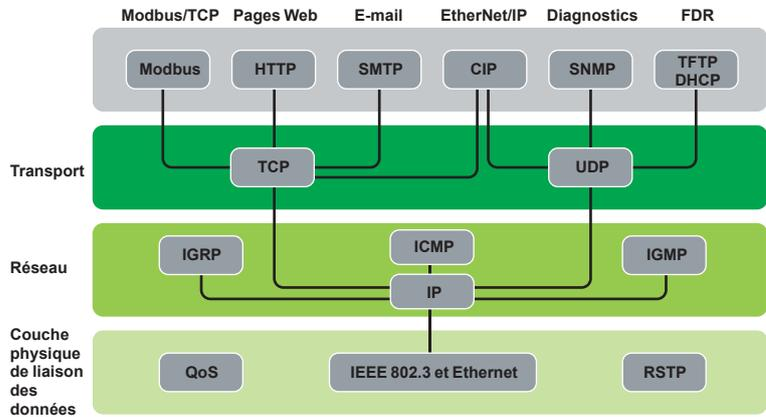
En complément des services Ethernet classiques (HTTP, BOOTP, DHCP, etc.), les modules de communication Ethernet sont associés à des systèmes d'automatismes, comme :
