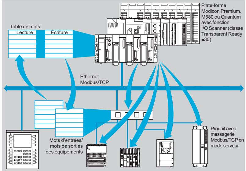
Le service I/O Scanning permet de gérer l'échange d'états d'entrées/sorties distantes sur le réseau Ethernet après une simple configuration et sans besoin de programmation spécifique.
