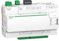
Com'X 510<br>24 VCC + PoE               | Energy Server +<br>gateway Ethernet                                  | Ethernet<br>Modbus<br>Smartlink SI<br>B, Zigbee<br>(ai misuratori<br>wireless) | Cavo Ethernet +<br>WiFi  | 64 dispositivi:<br>6 binari<br>2 analogici<br>32 dispositivi<br>Modbus + altri<br>dispositivi Ethernet<br>(Modbus TCP) | -      | EBX510    |
