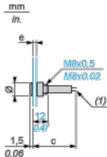
(1) Tag per connettori Faston o collegamenti saldati
