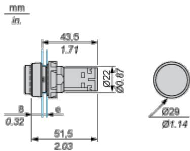
e Spessore pannello di supporto: da 1 a 6 mm/da 0.4 a 0.24 in. (metallo), da 2 a 6 mm/da 0.8 a 0.24 in. (plastica).
