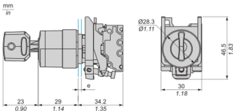
e: Spessore fissaggio: da 1 a 6 mm / da 0.04 a 0.24 in.
