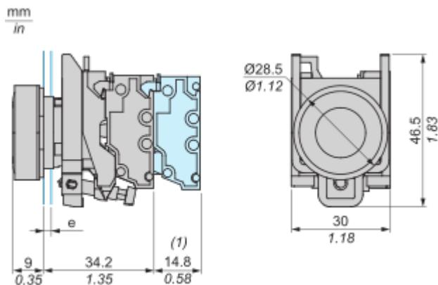
e: Spessore fissaggio: da 1 a 6 mm / da 0.04 a 0.24 in.
