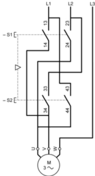
Combinato con blocco di isolamento a 3 poli XACS399 o XACS3991, illustrato nella posizione non attuato (stazione alloggiamento opzionale "alimentata"), dotato di arresto di emergenza a impulso ad aggancio con rilascio a chiave.
