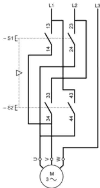
Combinato con blocco di isolamento a 3 poli XACS399 o XACS3991, illustrato nella posizione non attuato (stazione alloggiamento opzionale "alimentata"), dotato di arresto di emergenza a impulso ad aggancio con rilascio a chiave.
