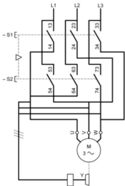
**Controllo motore 2 sensi di marcia velocità singola commutazione trifase, indietro tramite inversione bifase**
