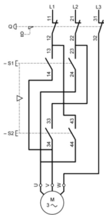
**Controllo motore 2 sensi di marcia 2 velocità commutazione 2 fasi**
