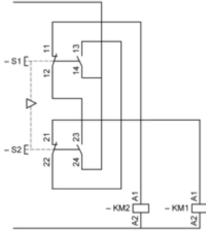
**Controllo motore 2 sensi di marcia 2 velocità**
