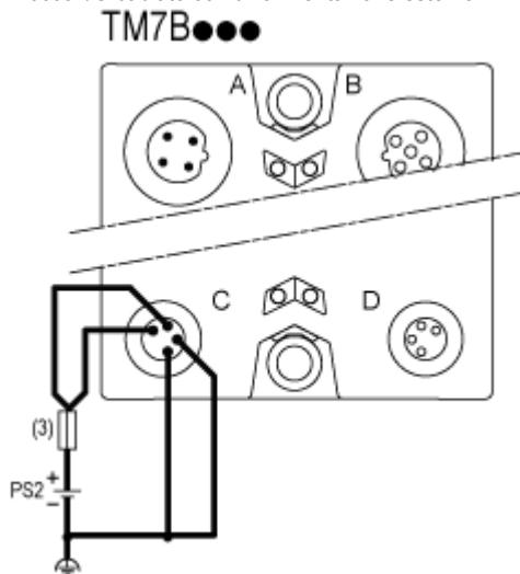
(3) Fusibile esterno tipo T ad azione lenta 8 A max. 250 V
