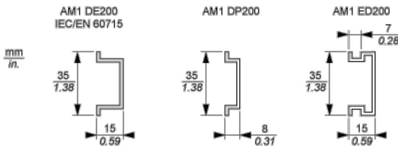
**NOTA:** solo i blocchi di dimensioni 1 (i più piccoli) possono essere installati su una guida DIN con la piastra di montaggio TM7ACMP.
