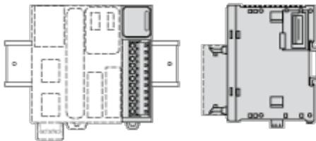
**Posizione di montaggio errata**
