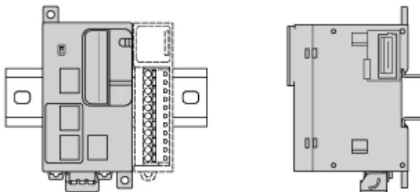
**NOTA:** Mantenere un spazio appropriato per assicurare una ventilazione corretta e una temperatura ambiente compresa tra -10°C (14°F) e 55°C (131°F).
