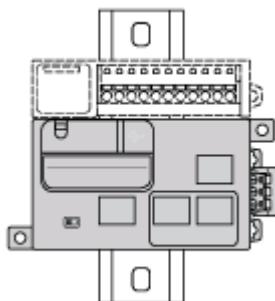
**NOTA:** I moduli di espansione devono essere montati sopra il controller.
