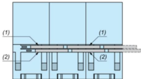
(1) 2 jumper del bus (polarità A2)
