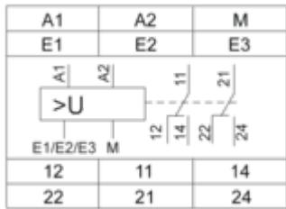
**A1, A2:** tensione di alimentazione**E1, E2, E3, M:** tensioni da misurare**11-14, 12:** 1° contatto C/O del relè di uscita**21-24, 22:** 2° contatto C/O del relè di uscita
