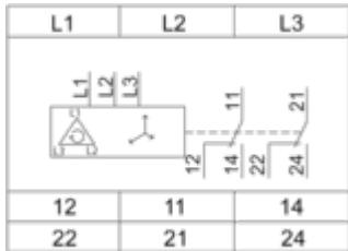
**L1, L2, L3:** alimentazione da monitorare**11-14, 12:** 1° contatto C/O del relè di uscita**21-24, 22:** 2° contatto C/O del relè di uscita
