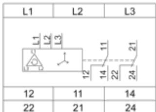
**L1, L2, L3:** alimentazione da monitorare**11-14, 12:** 1° contatto C/O del relè di uscita**21-24, 22:** 2° contatto C/O del relè di uscita
