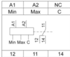
**A1, A2:** tensione di alimentazione**Max:** livello alto**Min:** livello basso**C:** riferimenti o elettrodo di terra del serbatoio**11-14, 12:** 1° contatto C/O del relè di uscita
