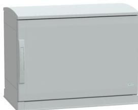
Armadio in poliestere, PanelSeT PLA, fondo aperto, tetto ventilato, 500x750x420mm, IP44, IK10
