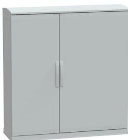
Armadio in poliestere, PanelSeT PLA, fondo aperto, tetto ventilato, 1250x1250x420 mm, IP44, IK10
