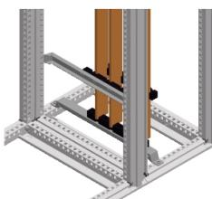
2 supporti sbarre verticali per 3200A con sbarre da 10 mm. Spacial SF, Distanza tra le sbarre: 115 mm. Per larghezze da 800 mm
