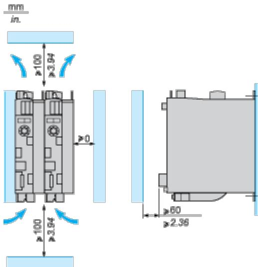
I servoazionamenti LXM32•U45M2, •U90M2 e LXM32•U60N4 vengono raffreddati tramite convezione naturale. I servoazionamenti LXM32•D18M2, •D30M2, LXM32 •D12N4, •D18N4, •D30N4 e •D72N4 sono dotati di una ventola integrata.
