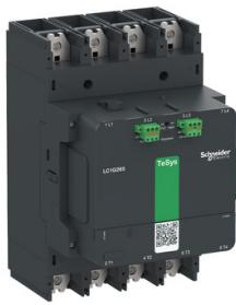
Contattore elevata potenza TeSys Giga, 4P (4NO), AC1 700A, versione Advanced, bobina elettronica 48...130V AC/DC
