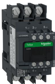
Contattore, TeSys Deca, 3P(3NO), AC-3/AC-3e, <=440V, 40A, bobinq 100...250V AC/DC, connessioni capicorda
