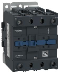
Contattore TeSys D - 4P (2 NA + 2 NC) - AC1 - <= 440 V 60 A - 230 Vca 50/60 Hz
