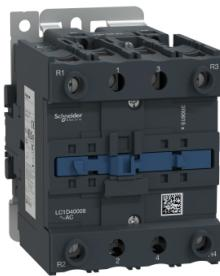
Contattore TeSys D - 4P (2 NA + 2 NC) - AC1 - <= 440 V 60 A - 42 Vca 50/60 Hz
