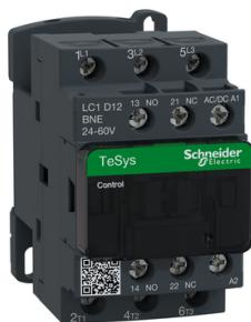
**TeSys D Green contattore - 3P - <= 440 V - 12 A AC-3 - 24...60 V AC/DC**
