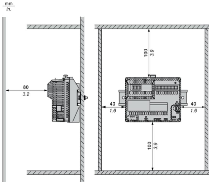
Mantenere una distanza adeguata per la corretta ventilazione al fine di mantenere la temperatura ambiente tra 0...50 °C (32...122 °F) per installazione orizzontale e 0...40 °C (32...104 °F) per installazione verticale.
