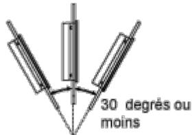
Quando si installa il pannello in posizione obliqua con inclinazione maggiore di 30°, la temperatura ambiente non deve superare 40 °C (104 °F). Potrebbe essere necessario l'uso di aria di raffreddamento forzata (ventilatori, A/C) per assicurare che la temperatura ambiente sia al massimo 40°C (massimo 104°F).
