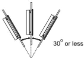
Quando si installa questo prodotto in posizione obliqua con inclinazione maggiore di 30°, la temperatura ambiente non deve superare 40°C (104°F). Potrebbe essere necessario l'uso di aria di raffreddamento forzata (ventilatori, A/C) per assicurare che la temperatura ambiente sia al massimo 40°C (massimo 104°F).
