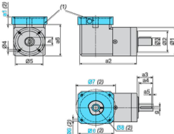
(1) Kit adattatore servomotore
