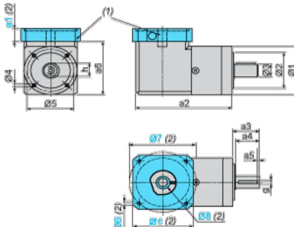
(1) Kit adattatore servomotore
