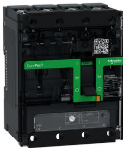
Interruttore, ComPacT NSXm 100H, 70kA/415VAC, 4 poli 3D (neutro non protetto), Sganciatore TMD 80A, busbar/connettori
