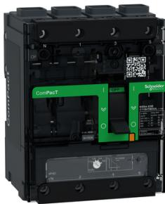
Interruttore, ComPacT NSXm 100B, 25kA/415VAC, 4 poli 4D (neutro totalmente protetto), Sganciatore TMD 50A, connettori EverLink
