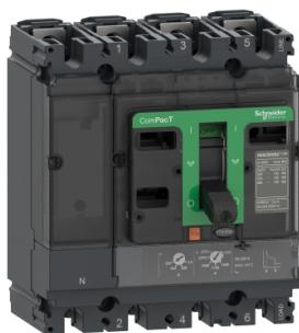
Interruttore, ComPacT NSX100R, 200kA/415VAC, 4 poli 4D (neutro totalmente protetto), Sganciatore TMD 80A
