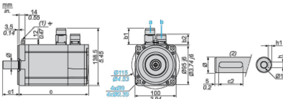
a: Alimentazione per freno servomotore
