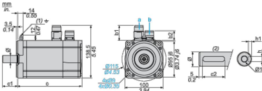
a: Alimentazione per freno servomotore
