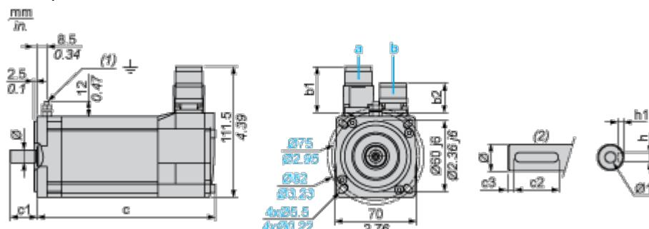
a: Alimentazione per freno servomotore
