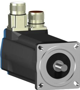
**Servomotore BSH070 1,4Nm albero con chiavetta IP54 SingleT 128 Sin/Cos no freno connettori 90°**
