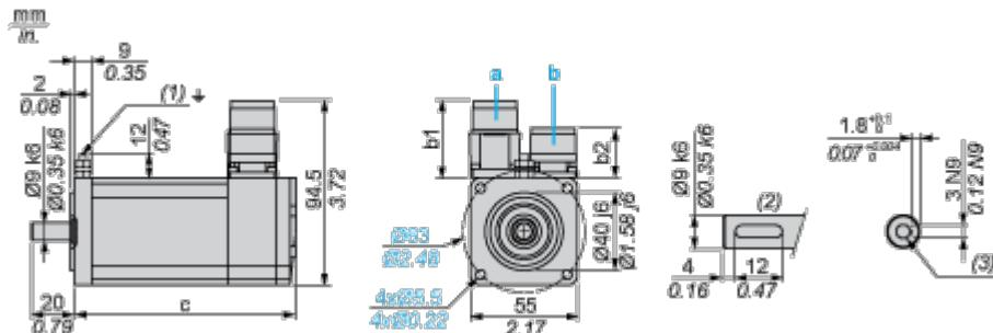
a: Alimentazione per freno servomotore
