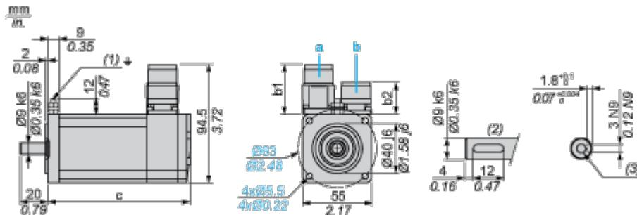
a: Alimentazione per freno servomotore
