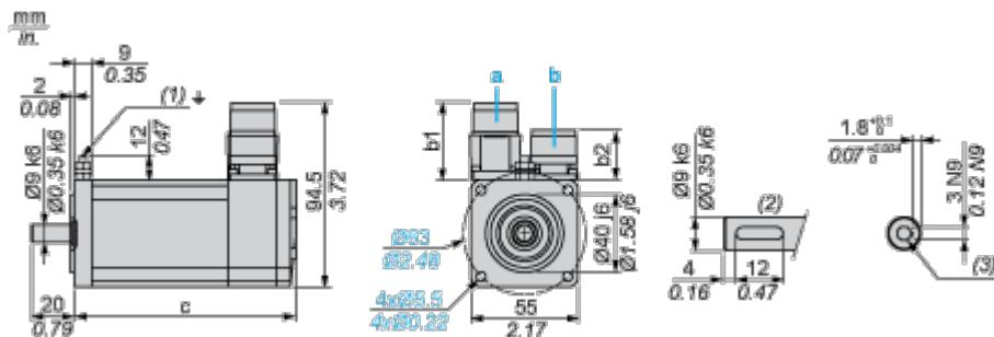
a: Alimentazione per freno servomotore
