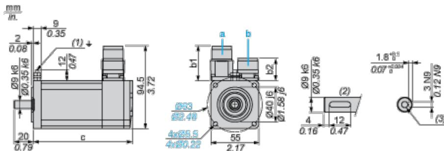
a: Alimentazione per freno servomotore
