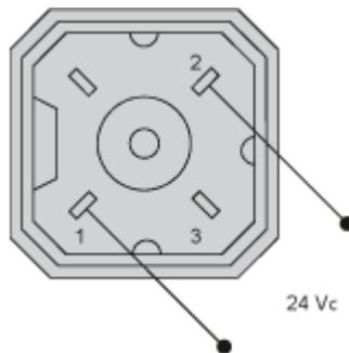
Il connettore fa parte della fornitura. Designazione connettore: Hirschmann tipo G4 A 5M
