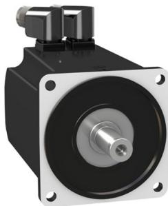
**Servomotore BMH140 10Nm albero con chiavetta IP54 SingleT 128 Sin/Cos no freno connettori 90°**
