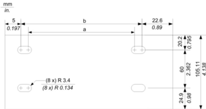
**NOTA:** Nei fori di fissaggio possono essere inserite viti M4, M5, M6 o UNC #6.
