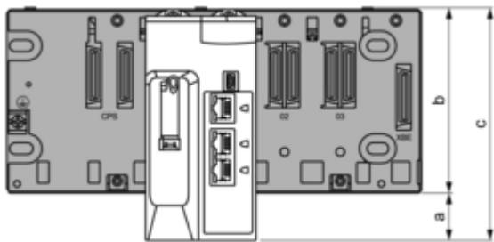
**a:** Spazio aggiuntivo sotto il rack adeguato all'altezza della CPU. Per un rack X Bus, il valore è 30,9 mm (1,217 pollici.); per un rack Ethernet, il valore è 29,49 mm (1,161 pollici.).
