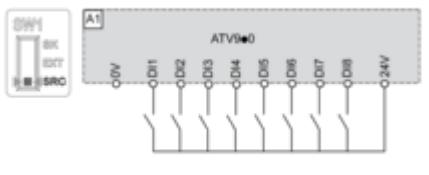
**Commutatore impostato in posizione SRC (Source) e utilizzo di un'alimentazione esterna per gli ingressi digitali**
