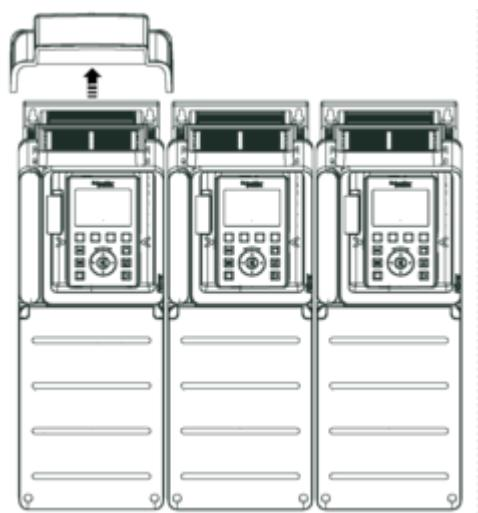
**Tipo di montaggio C: singolo IP20**
