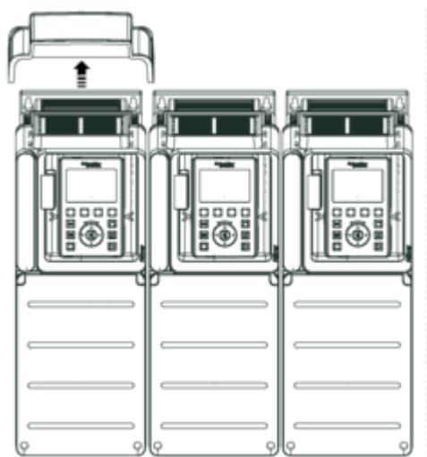
**Tipo di montaggio C: singolo IP20**
